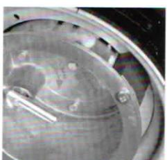
21. Wenn der **Abstand** zwischen den Rädern sehr gross ist, montieren Sie beide Zwischenstücke auf der Innenseite des Randes vom Kupplungsgehäuse.
