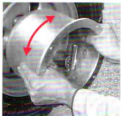
14. Fahren Sie jetzt den **Zentrierzapfen** in das **Zentrumloch** und **drücken** das Kupplungsgehäuse gegen das Fahrzeug, drehen es anschliessend in beliebiger Richtung bis es gegen das Fahrzeug hineinrückt.
