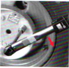
8. Spannen Sie die **Schrauben** zuerst auf halbe und dann auf volle Spannung fest wie unter **Schema 5** beschrieben. Das **maximale Anzugsmoment** ist 72 Nm (7,2 kg/M).
