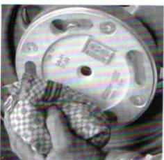
11. Damit sich Clic-Doppelräder leicht ankuppeln lassen, reinigen Sie die Kupplungsflächen mit einem Putzlappen vor jedem Ankuppeln der Doppelräder. Das Fahrzeugrad ist jetzt für die Aufnahme des Clic-Doppelrades vorbereitet.
