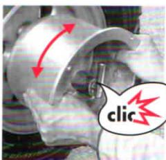
15. Drehen Sie jetzt kräftig nach **rückwärts** in Fahrtrichtung Ihres Fahrzeugs bis die beiden Hebel deutlich hörbar **ein-clicen**. Das Kupplungsgehäuse ist jetzt spielfrei mit dem Fahrzeugrad verbunden.
