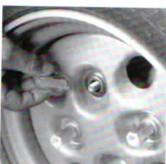
4. Entfernen Sie jetzt die restlichen Radmuttern und **montieren** Sie die verbleibenden **AdAPTERMUTTERN**.
