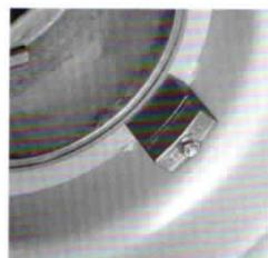
19. Falls **kein Abstand** zwischen der Rad Scheibe Bild 19 und dem Rand des Kupplungsgehäuses ist, **montieren Sie beide Distanzstücke** auf der Innenseite vom Rand des Kupplungsgehäuses oder auf der Außenseite des Doppelrades.
