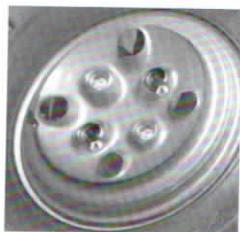
3. Schrauben Sie an die leeren **Bolzen 2 AdAPTERMUTTERN**, so dass eine evtl. Ansenkung gegen das Fahrzeugrad zeigt. (Einige Fahrzeug **Typen** haben flache Radmuttern, dann ist auch die Adaptermutter flach). Ziehen Sie diese **2 Muttern** mit dem Schlüssel auf halbe Endspannung fest.
