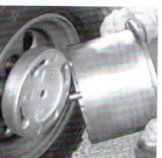
13. Stellen Sie sicher, dass Sie das **richtige Kupplungsgehäuse** in der Hand halten. Beachten Sie dazu die Markierung für **Fahrrichtung «rechts bzw. links»** (innen aufgegossen).
