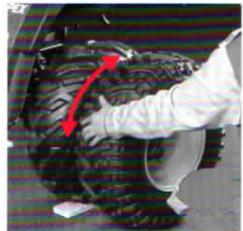
27. Nachdem Sie mit dem Zentrierbolzen in das Zentrierloch eingefahren sind, drücken Sie das **Doppelrad** mit beiden Händen gegen das Fahrzeugrad und drehen es gleichzeitig in beliebiger Richtung.
