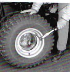
25. Alle **Muttern** zuerst mit ca. halber Spannung **anziehen**, dann gemäss **Bild 5** festziehen. Zum An- und Abkuppeln fahren Sie Ihr Fahrzeug am besten auf ein **ca. 30 mm dickes Brett** (beim Clic Pick-up in Lieferumfang enthalten). Das Anzugsmoment ist **32 Nm (3,2 kg/M max)**.
