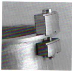
22. Der Rand an den Zwischenstücken hält diese in der richtigen Position. Montieren Sie diese immer so, dass die **Flächen voll** aufeinander liegen. Der Führungsrand führt am Kupplungsgehäuserand aussen.
