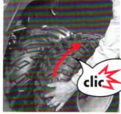
28. Sobald das Doppelrad gegen das Fahrzeug einrückt, drehen Sie das Doppelrad mit **Schwung kräftig** in Fahrtrichtung nach hinten, bis es deutlich hörbar einklickt!
